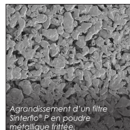
Coupe transversale d'un filtre Sinterflo® P en poudre métallique frittée.
