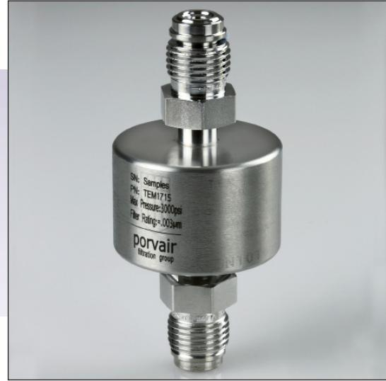
**GasPro™ TEM-1700** 系列过滤器专门针对需要紧凑、全金属设计的 **UHP** 半导体气体过滤而设计。当需要低压降且空间有限时，这款全焊接组件将提供 **0.003** 微米的颗粒截留等级。
