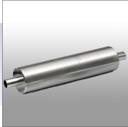
**GasPro™ TEM-300** 系列过滤器专门为过滤半导体级惰性气体和 **CDA** (清洁干燥空气) 而设计。这款全焊接总成可在需要高流速且空间有限的场合提供0.003微米的颗粒截留能力。
